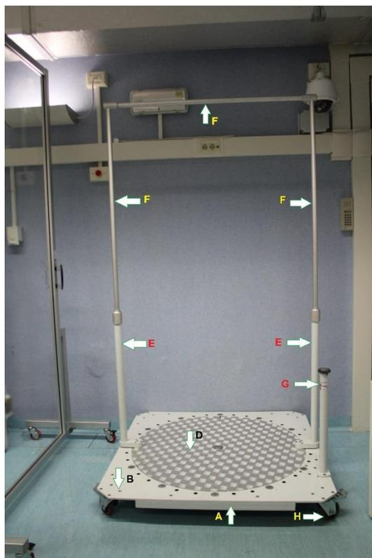
**Struttura portante A** in lega di alluminio EN AW 5083 sormontato da una **piastra B** in acciaio FE S235 EN 10027.
