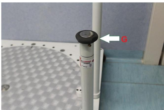
Sul perimetro esterno della piastra B è fissata la manopola del **freno di stazionamento G**, con funzione anche di frizione
